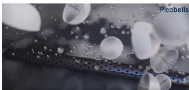
Cevni prezračevalnik na dnu bioreaktorja dovaja kisik
